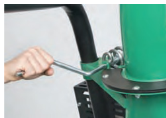
DL2900, Auswurfkamin 360° werkzeuglos schwenkbar
